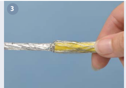
3 Schirmgeflecht über den Kabelmantel ziehen. Pull back the copper braid.
