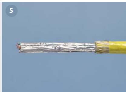
5 Bündelverseilung aufdrehen. Untwist the pairs.
