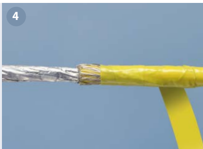
4 Schirmgeflecht mit Isolierband fixieren. Fix the copper braid with tape.
